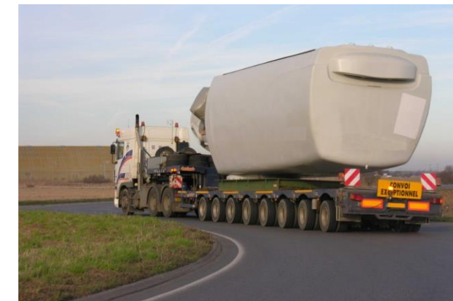
Transport de la nacelle
